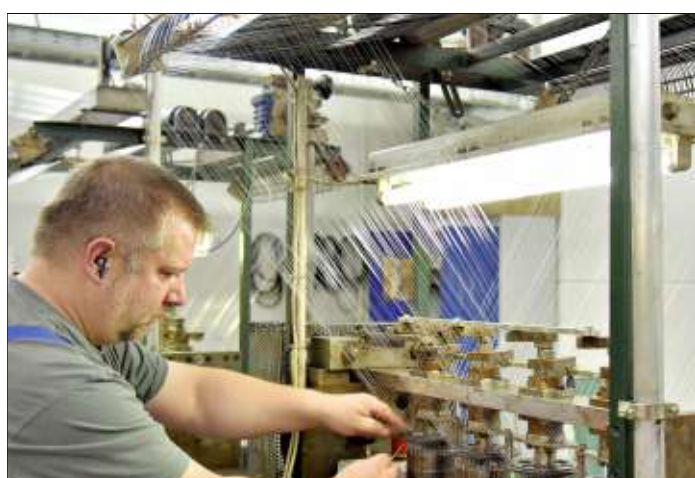
MMitarbeiter überwachen ständig die Maschinen, damit Produktionsstörungen sofort behoben werden können, so wie hier zum Beispiel ein Fadenriss.
