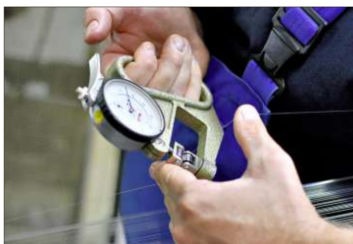
Belastungstest: Die Stärke der feinen Fäden, aus denen dann die Netze hergestellt werden, wird auch während der Produktion regelmäßig überprüft.
