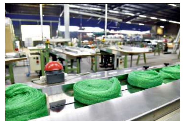
Auch Vogelschutznetze stellt das Unternehmen her. Bevor sie in den Handel gelangen, werden sie an Laufbändern verpackt und anschließend etikettiert.
